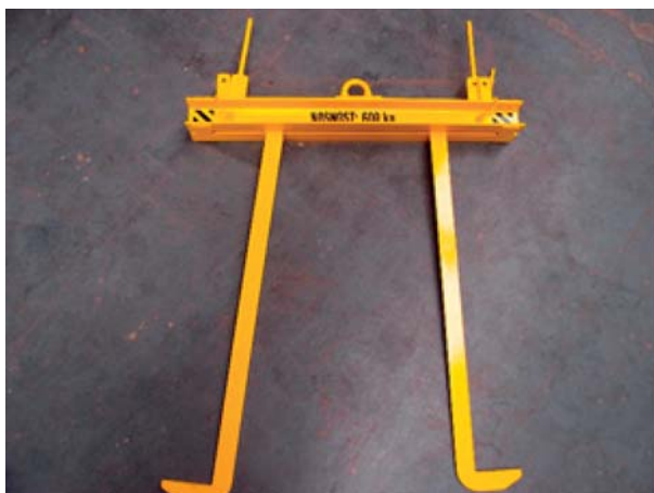
Obr. 4.1 Manipulační přípravek „hokejky“ pro manipulaci prvků štěrbinových žlabů skrz rám poklopu / mříže, stavitelná rozteč dle daných pozic.
