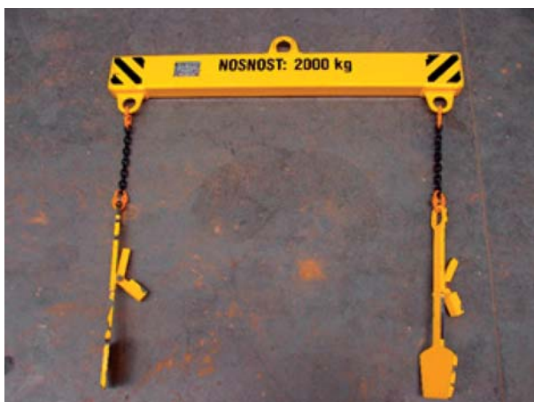
Obr. 4.2 Manipulační přípravek „lopatky“ (dvojice) pro manipulaci se štěrbinovým žlabem skrz vtokovou štěrbinu.
