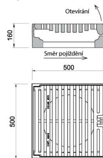
Mříž s rámem D400 s pantem speciál 16 mm (KM14P)
