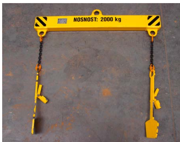
Obr. 4 Manipulační přípravek „lopatky“ (dvojice) pro manipulaci se štěrbinovým žlabem skrz vtokovou štěrbinu.
