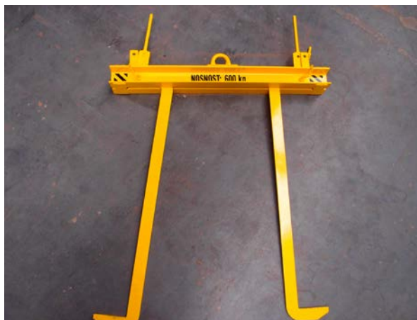
Obr. 3 Manipulační přípravek „hokejky“ pro manipulaci prvků štěrbinových žlabů skrz rám poklopu / mříže, stavitelná rozteč dle daných pozic.
