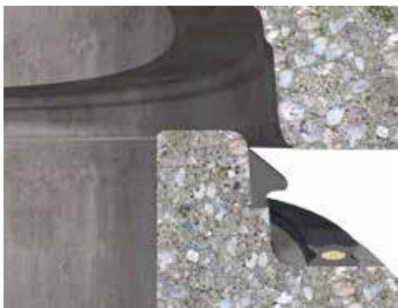
Vkládané těsnění standardní, na které je potřeba aplikovat kluzný prostředek.
