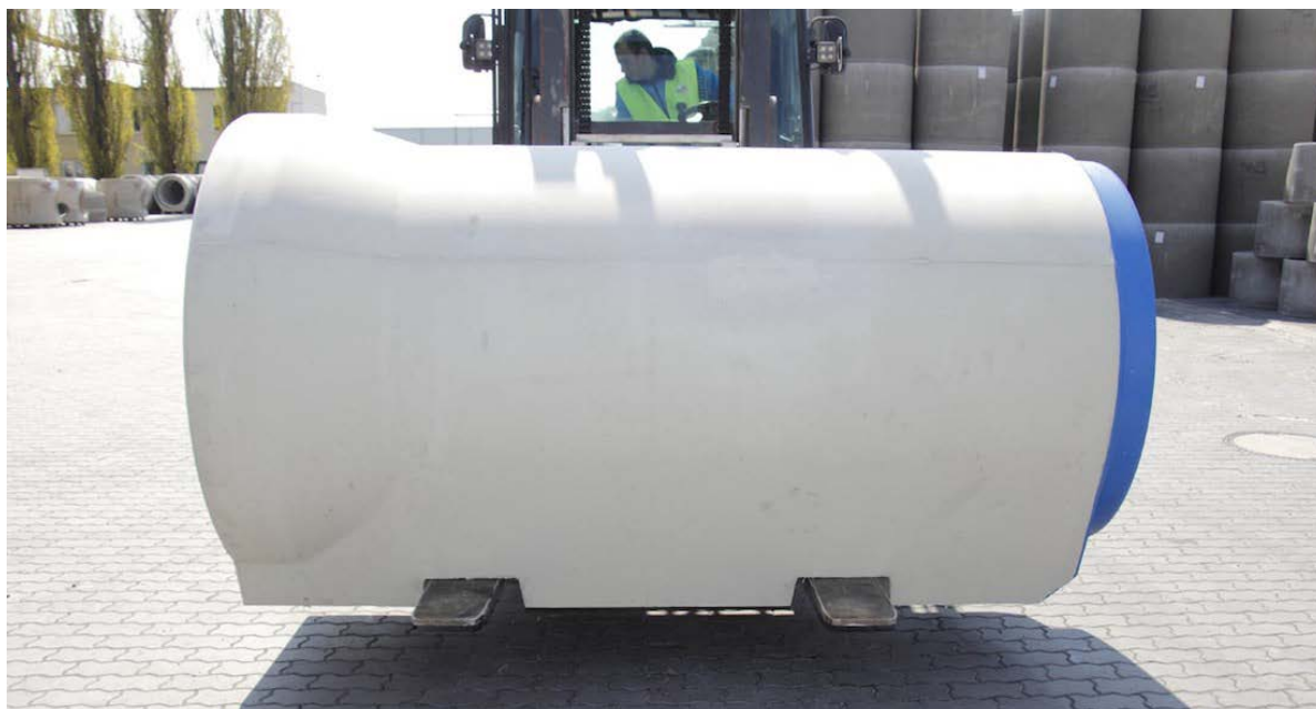
Obr. 3 Příklad manipulace trouby hrdlové patkové DN 1000 CV 360 a DN 1200 CV 360 pomocí vysokozdvížného vozíku za vybrání v patce trouby
