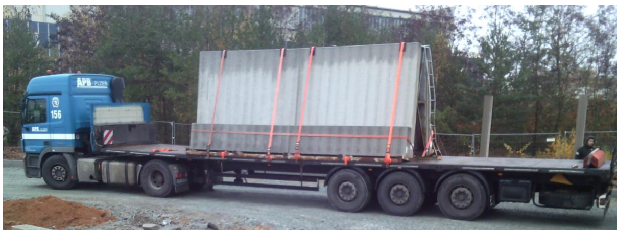
Obrázek 2 Příklad dopravy panelů pomocí podpěr tzv.: „Á-ček“.
