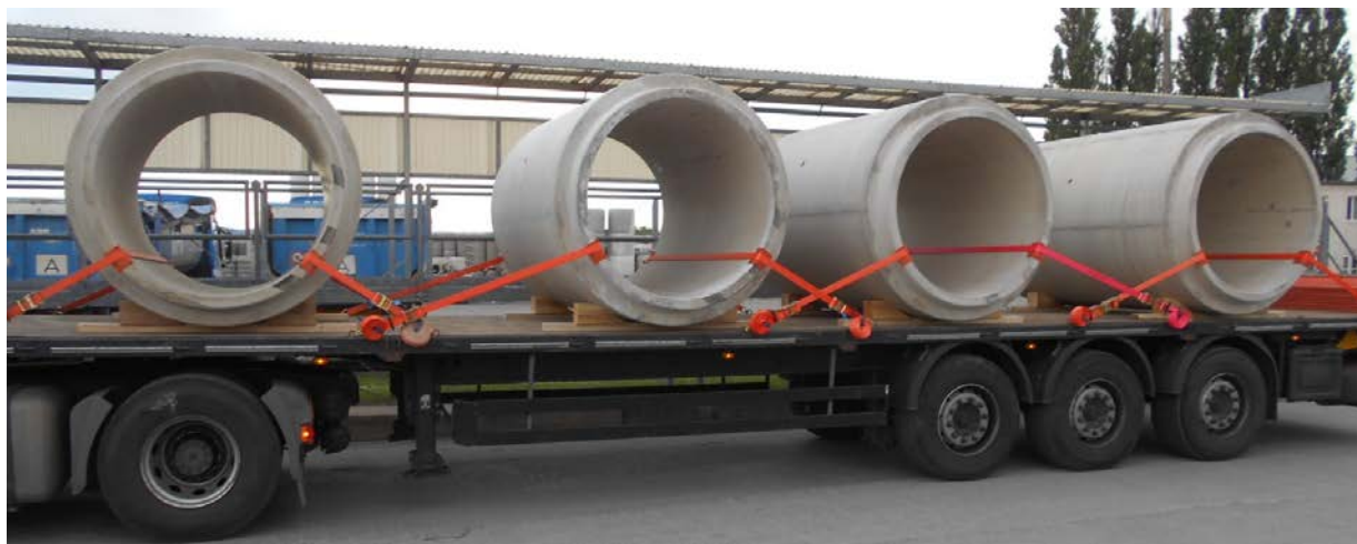
Obr. 1 Příklad zajištění trub při přepravě
