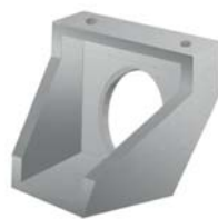
B&BC Čelo propustku
