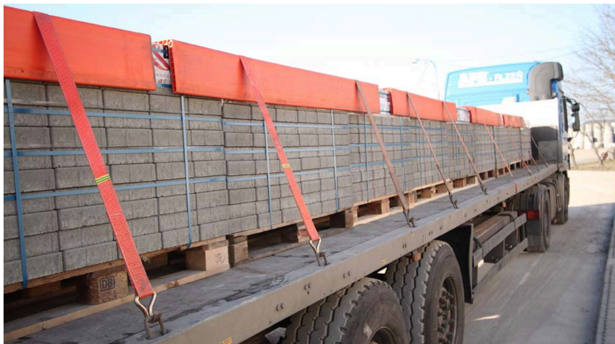
Obr. 1 Příklad dopravy dlažby na paletách a zajištění při přepravě.
