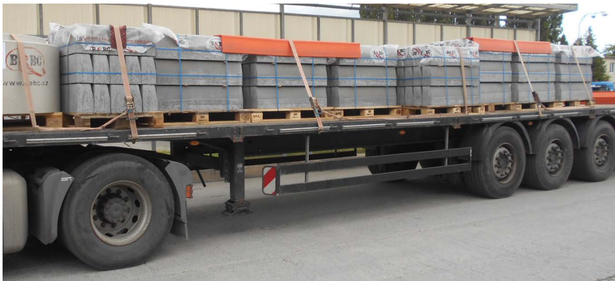
Obr. 2 Příklad dopravy obrubníků na paletách a zajištění při přepravě.
