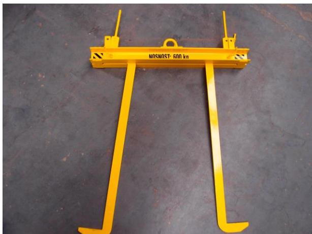
Obr. 1 Manipulační přípravek „hokejky“ pro manipulaci prvků štěrbinových žlabů skrz rám poklopu / mříže, stavitelná rozteč dle daných pozic.
